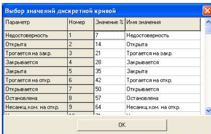
Рисунок 34 - Пример определения уровней позиционного сигнала для задвижки
